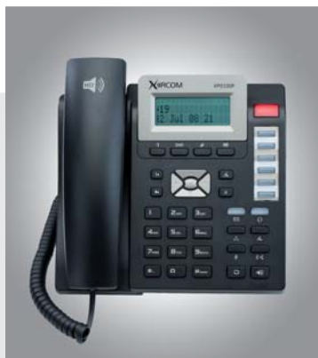
El XP0100 es un teléfono SIP básico de dos líneas.
