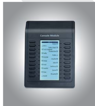
El XP0020 es el módulo de expansión que provee una botonera adicional para complementar los modelos XP0120/P.
